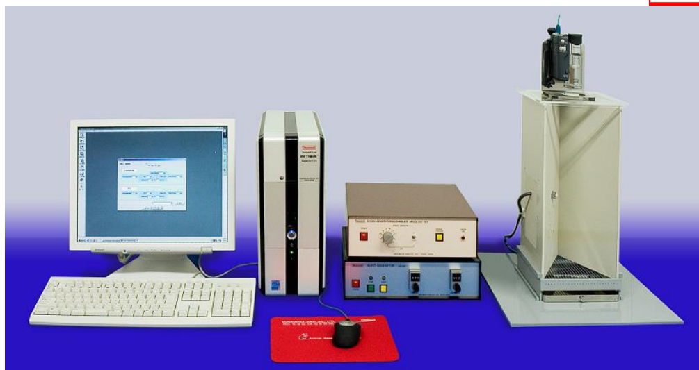
ビデオ・トラッキング・システム CompACT VAS/DV を使用時の設置例
